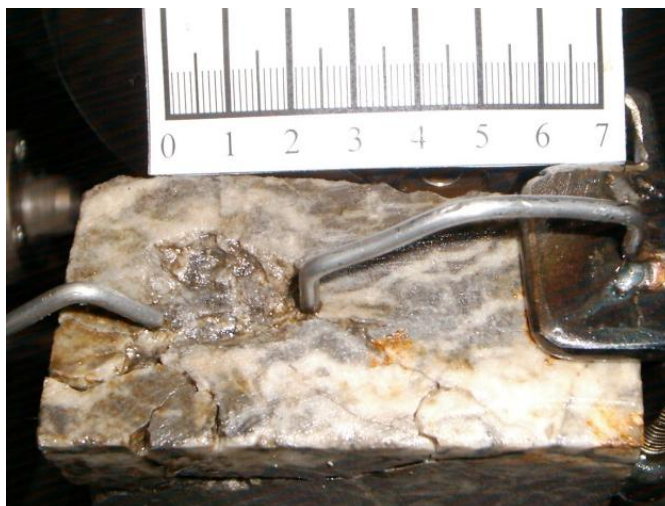
Рисунок 7. Экспериментально полученная откольная каверна при электровзрыве в известняке
