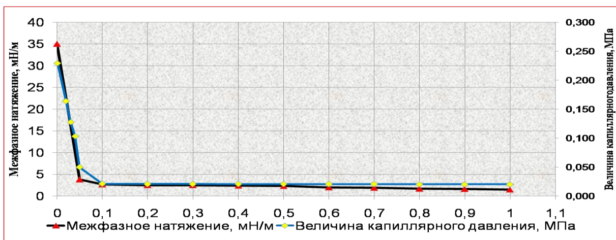
Рисунок 2. Зависимость межфазного натяжения и капиллярного давления от концентрации ПАВ.
