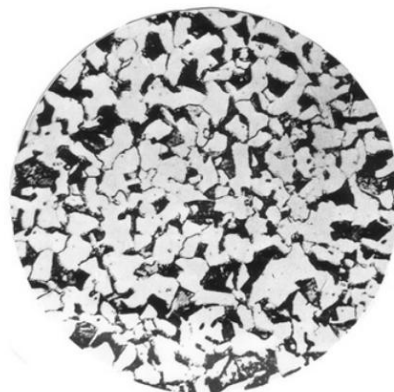
Рисунок 1. Микроструктура среднеуглеродистой стали 45: феррит (светлый) и перлит (темный).
