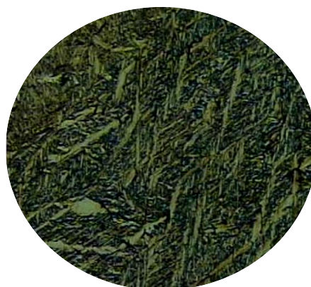
Рисунок 2. Микроструктура среднеуглеродистой стали 45 после закалки: мартенсит
