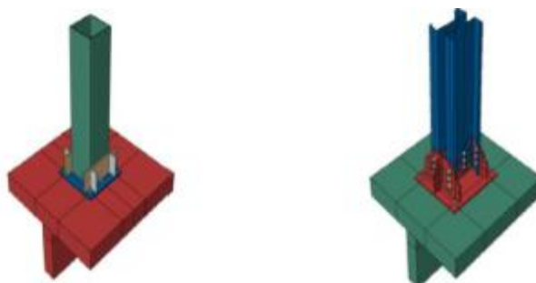
Рисунок 4. Полужесткие и жесткие базовые соединения
