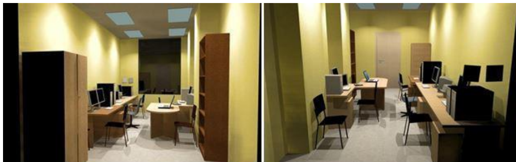
Рис. 8. Работа со сценами освещения: а – сцена с учетом естественного освещения при отключенных светильниках; б – сцена освещения с учетом работы светильников и коэффициентом естественного освещения
