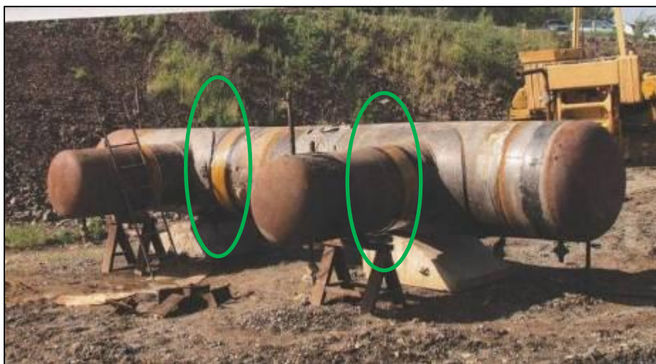
Рисунок 6. Стенд для гидравлических испытаний, зеленым цветом обведены места установки муфт
