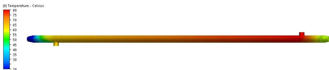
Рисунок 2. Распределение температуры в секции без перегородок
