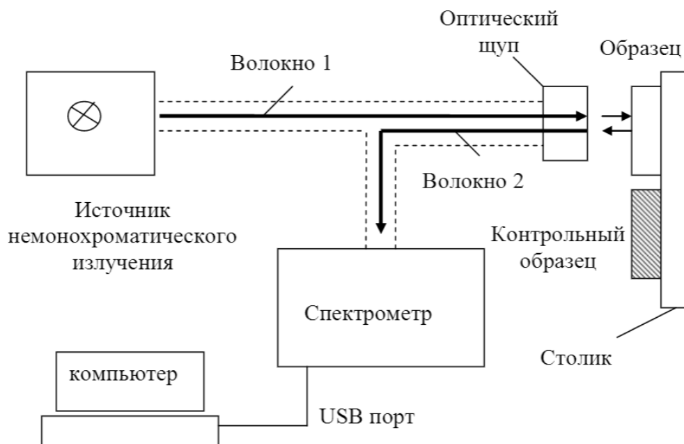
Рисунок 2. Схема установки для измерения спектров отражения.
