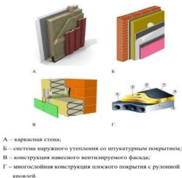
Рисунок 5 – Многослойные строительные конструкции
