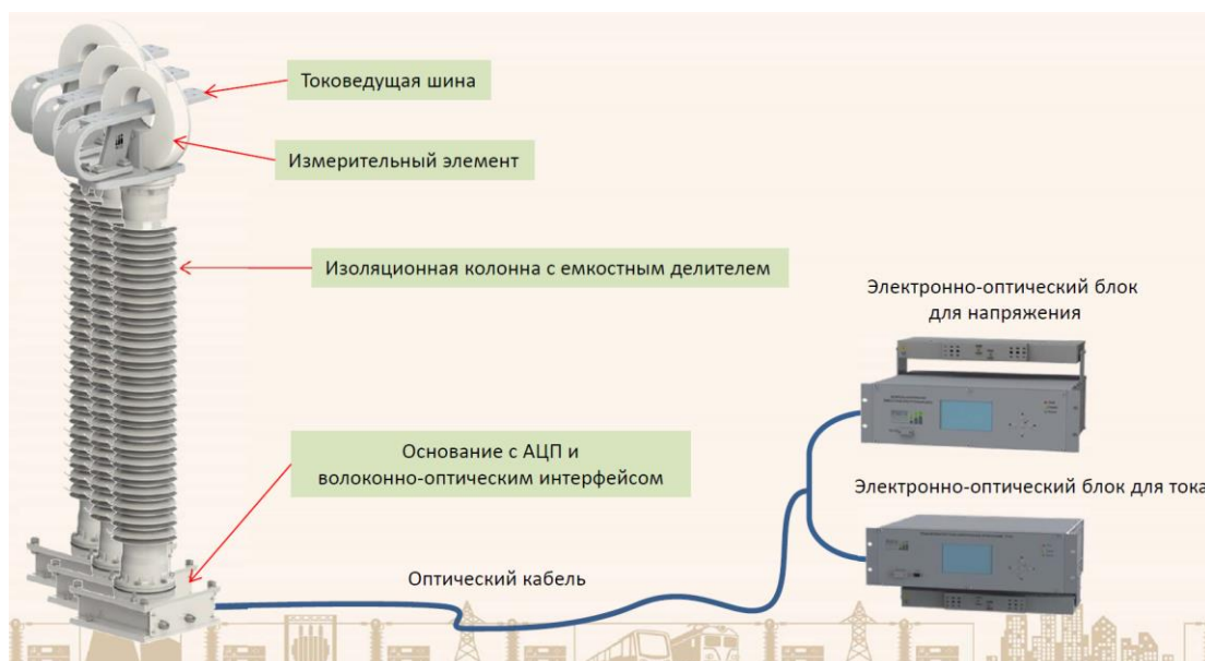
Рисунок 3 – Конструкция комбинированного ОТТН
