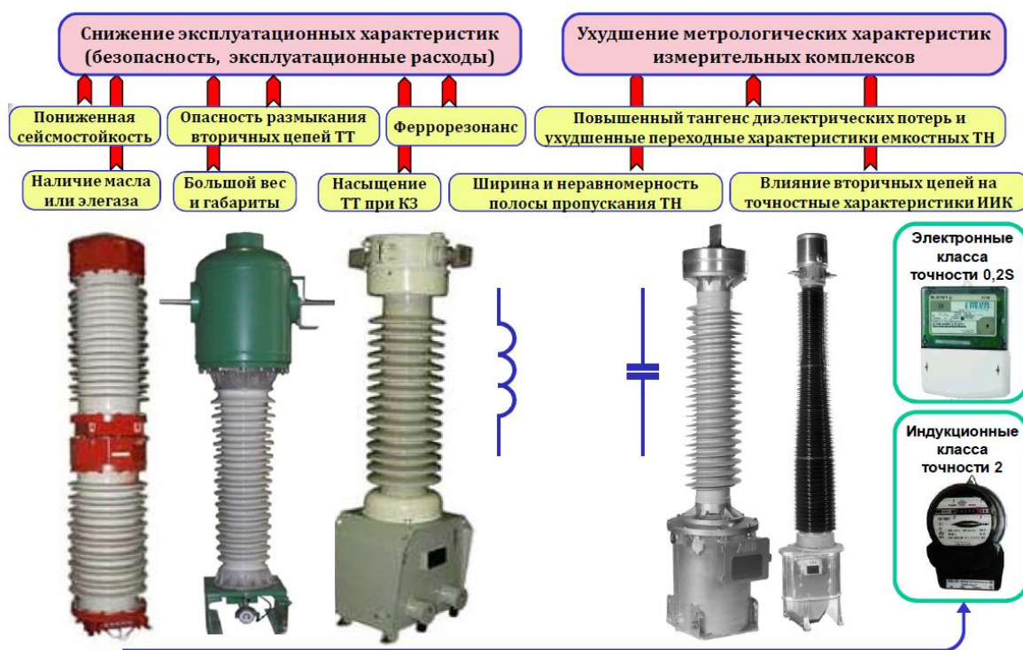
Рисунок 4 – Ключевые недостатки измерительных трансформаторов с ферромагнитным сердечником
