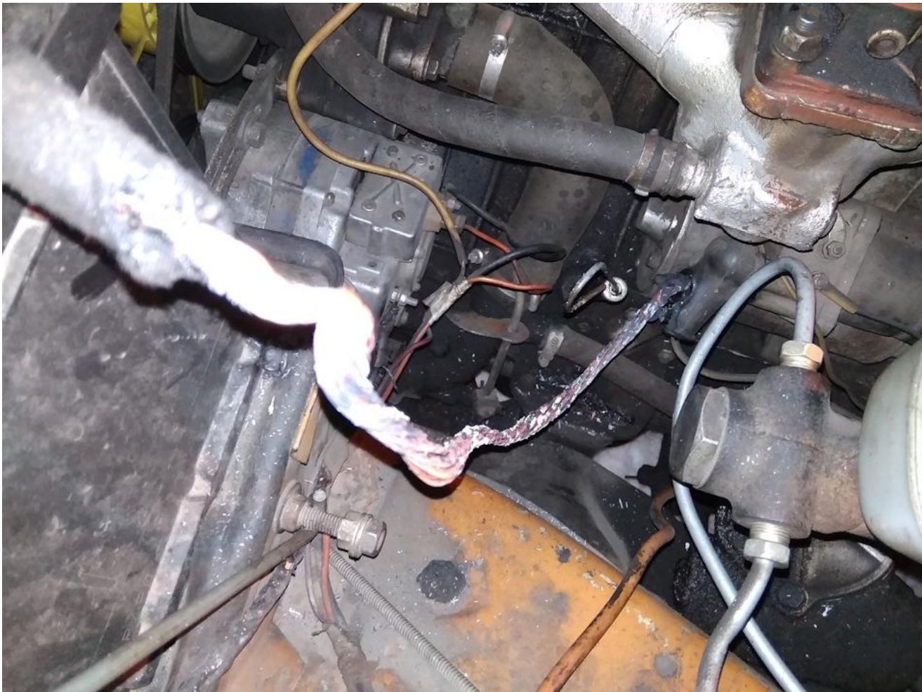
Рис. 2. Дефект в плюсовом электрическом проводе питания стартера привел к возникновению короткого замыкания с крышкой сцепления и последующему возгоранию
