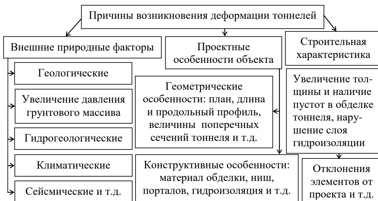
Рисунок 1 – Основные причины возникновения деформаций тоннелей
