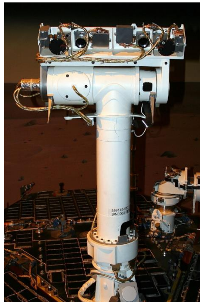
Рисунок 7. Мачта марсохода с двумя камерами Pancam и двумя навигационными камерами Navcam
