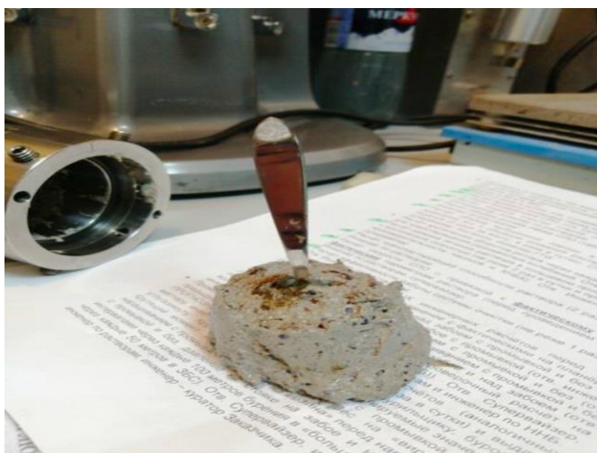
Рисунок 3 Термостарение в герметичной ячейке под давлением, содержание высушенной глины (имитация выбуренной породы) 56 кг/м 3 (время 2ч; t=55 °C; P=42 атм.).
