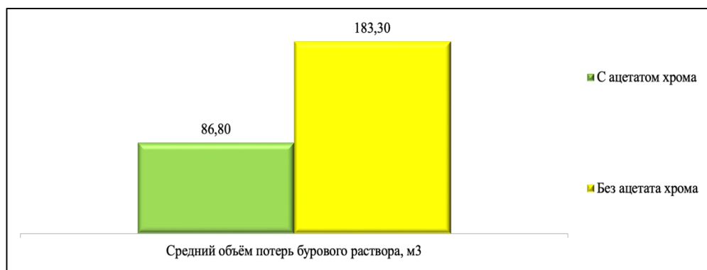
Рисунок 2 Средний объем потерь бурового раствора при ликвидации катастрофических поглощений с использованием ацетата хрома и применением базовых составов на объектах эксплуатационного бурения.
