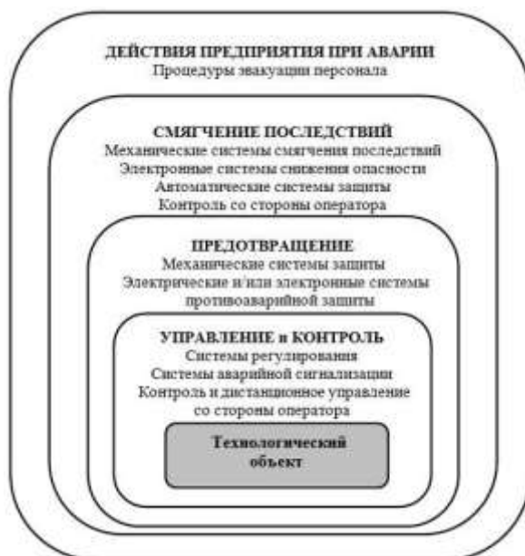
Рисунок 2. Типичные слои защиты и функции безопасности, применяемые для снижения рисков на объектах нефтегазодобычи
