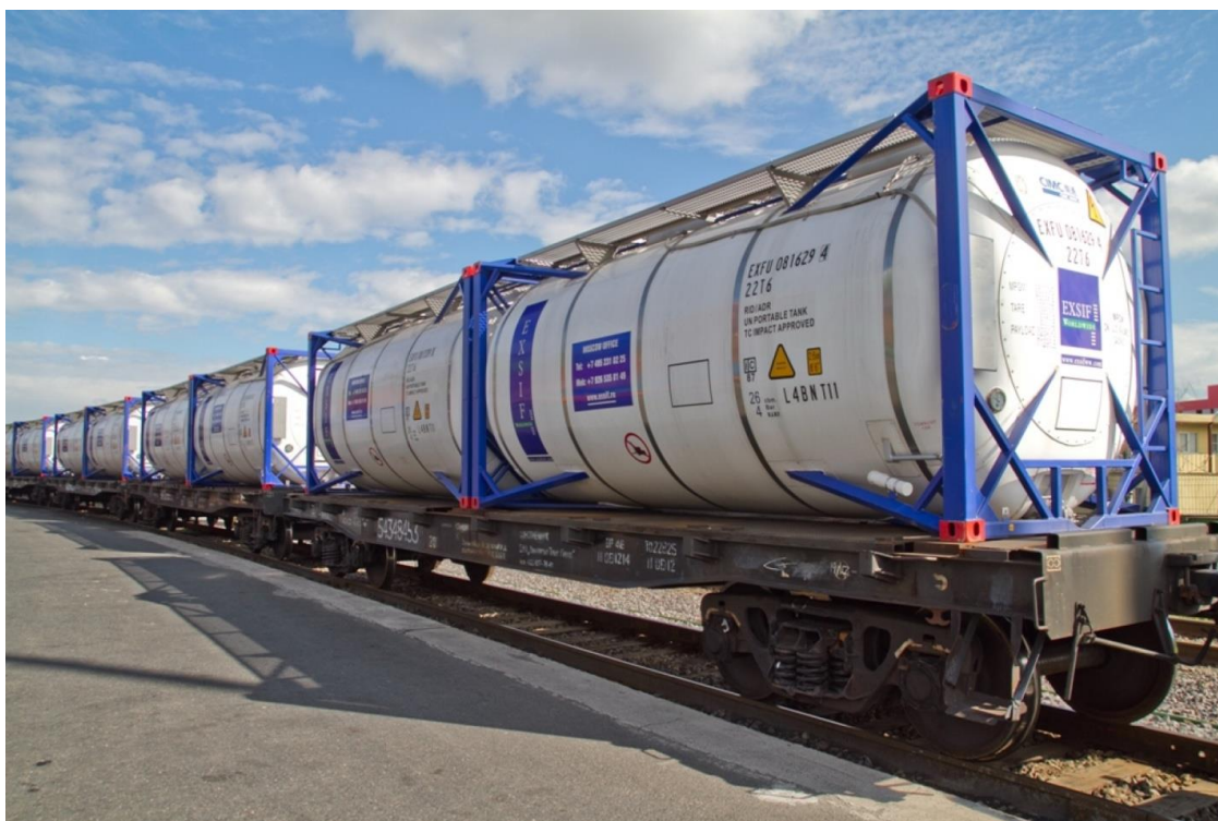
Рисунок 1. Размещение и крепление танк-контейнера на платформе
