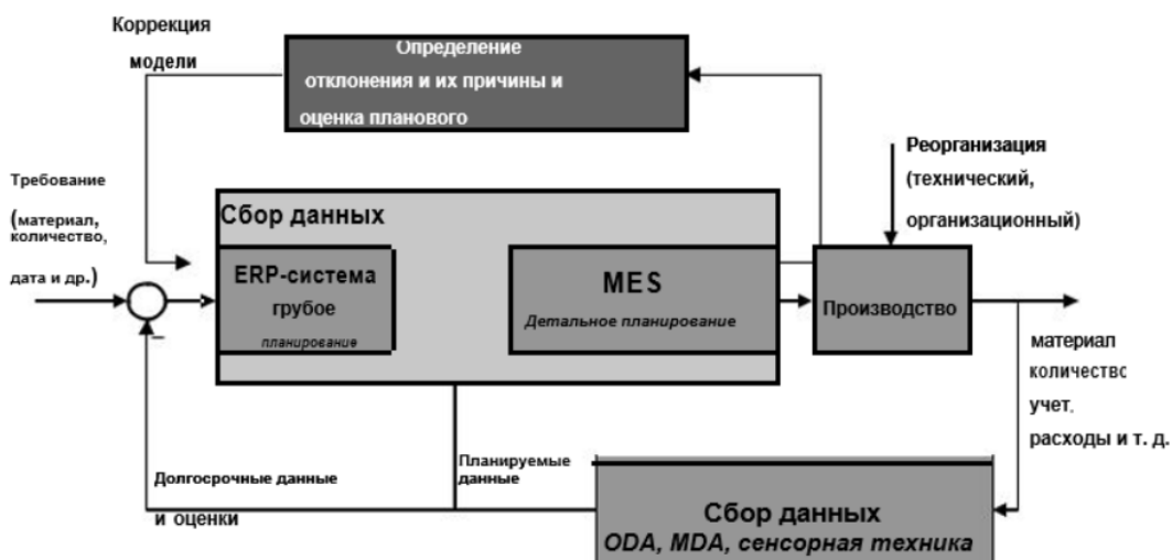
Рисунок 3 – Контур управления для оценки прогнозной надежности системы производства
