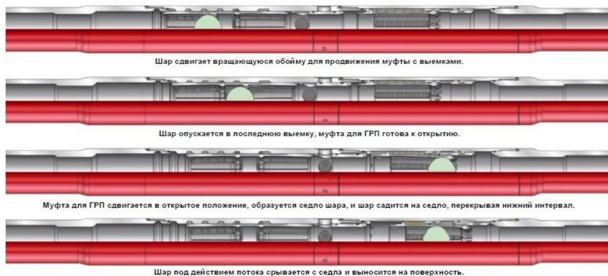
Рисунок 2 – Обзор механизма работы новой муфты для ГРП.
