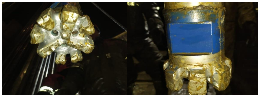
Рисунок 2. Зарезное долото с высокой боковой фрезерующей способностью калибрующей части
