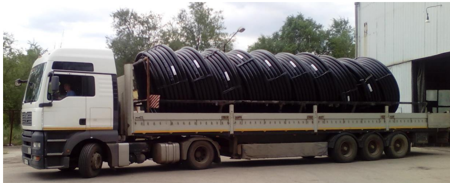
Рисунок 2 - Транспортировка полимерных труб в бухтах
