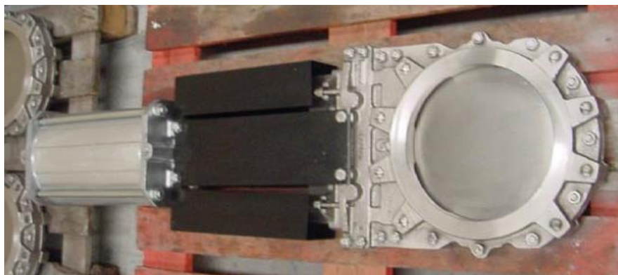
Рис. 3 Опытная модель высокопоточной задвижки
