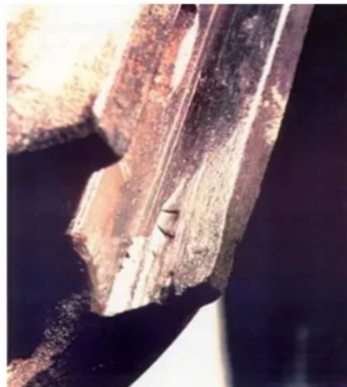
б) повреждение вдоль паза затвора
