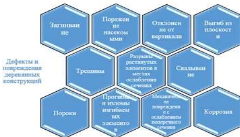
Рисунок. 1 Дефекты и повреждения деревянных конструкций
