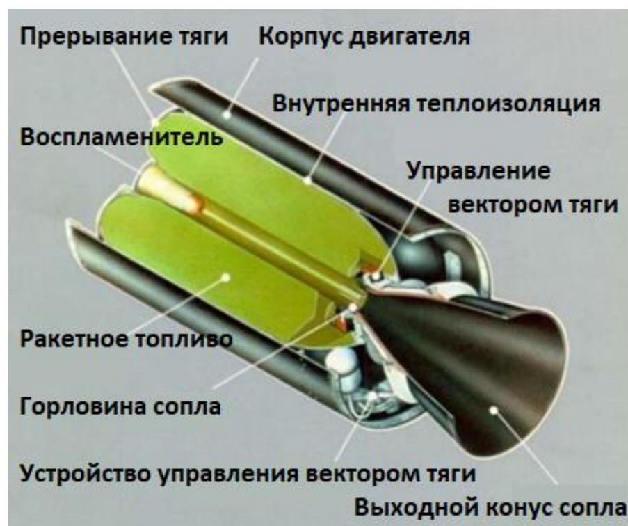
Рисунок 1. Схема твердотопливного ракетного двигателя [2 с. 3], прим.: перевод с англ. автора
