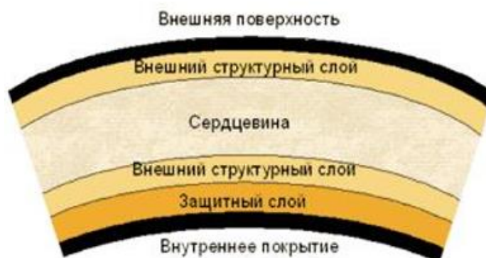
Рисунок 1 – структура стеклопластиковой трубы
