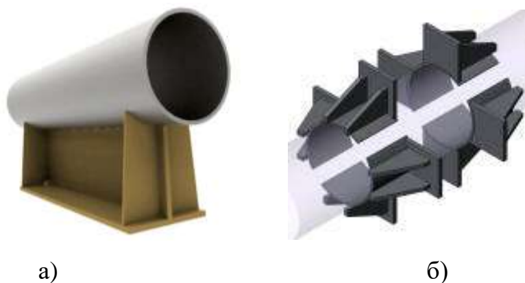
Рисунок 2 – Опоры: а) корпусные приварные опоры; б) опоры щитовые
