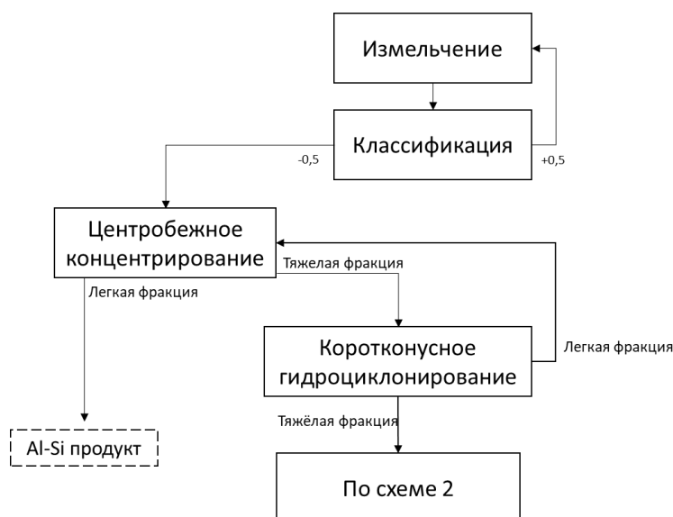
Рисунок 3. Схема центробежного дообогащения (схема 3)
