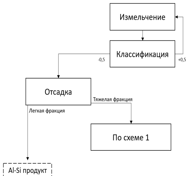
Рисунок 2. Вспомогательная схема дообогащения для крупных частиц
