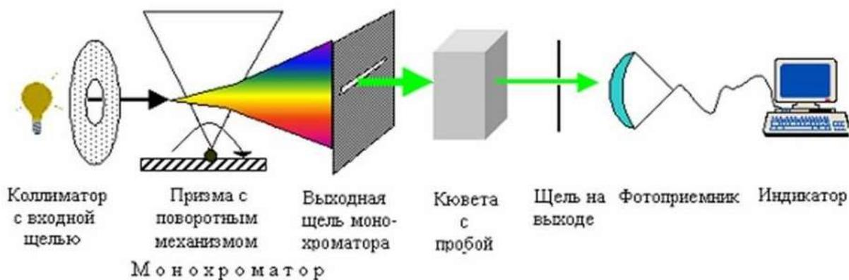
**Рисунок 1. Основные компоненты спектрофотометра**
