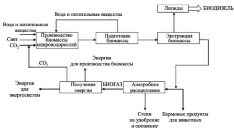
Рис. 3. Принципиальная схема получения биодизеля и биогаза из микроводорослей
