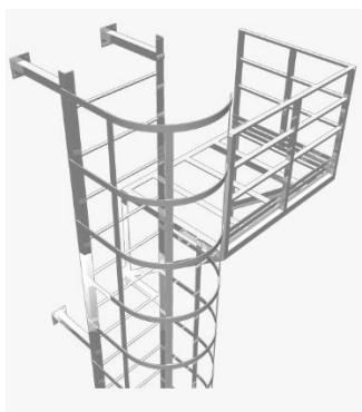
Рисунок 1. Стационарная лестница пожарного.
