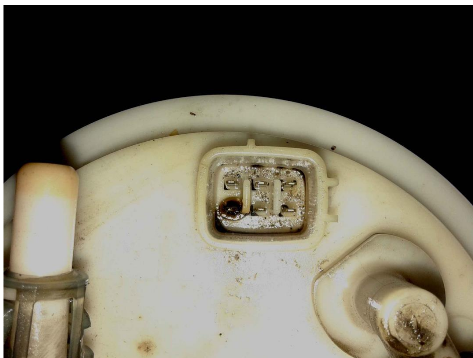
Рис. 2. Возникновение БПС в клеммном разъёме топливного насоса Subaru Forester 2004 года выпуска
