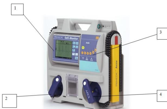
Рисунок 1 – Дефибриллятор Primedic Defi-Monitor ECO-1 METRAX (1-ЭКГ-монитор, 2, 4 – встроенные разрядные электроды, 3 – панель для выбора режима дефибрилляции)
