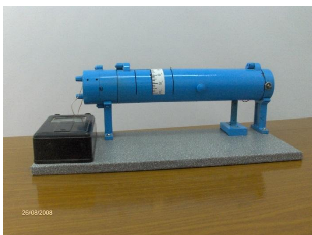
Рисунок 1. Установка по изучению поляризации света
