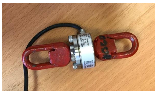
Рисунок 2. Тензодатчик UMM – К20
