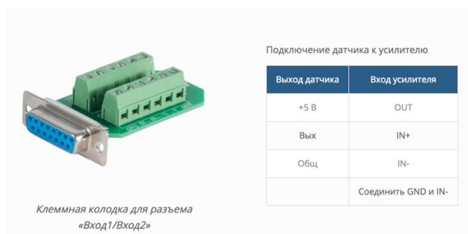
Рисунок 5. Клеммные колодки для усилителя и преобразователя
