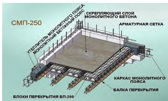
Рисунок 1 – Общая конструктивная схема сборно-монолитного перекрытия
