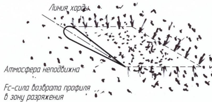
Рисунок 4. Взаимодействие неподвижной атмосферы с движущимся профилем крыла
