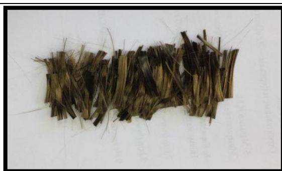
Рис.1. Базальтовая фибра в исходном состоянии
