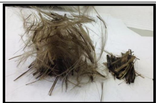
Рис.2. Базальтовая фибра после «распушевки» специальным смесителем
