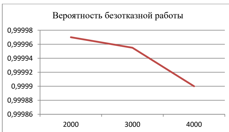
Рисунок 4 - Зависимость вероятности безотказной работы от времени
