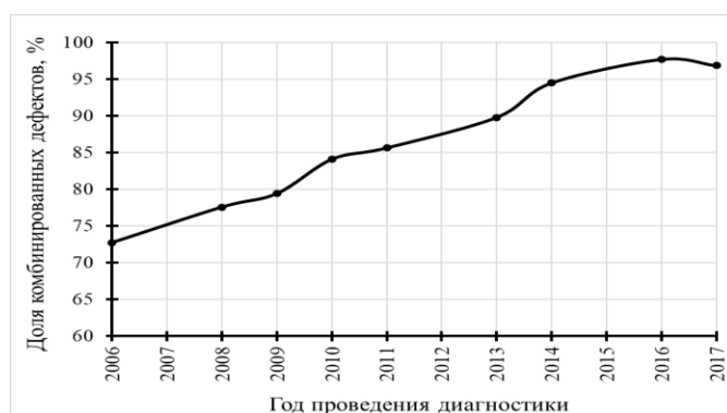
Рис. 1. Доля комбинированных дефектов среди общего числа опасных дефектов в разные годы проведения внутритрубной диагностики (участок МН «Ухта – Ярославль»)
