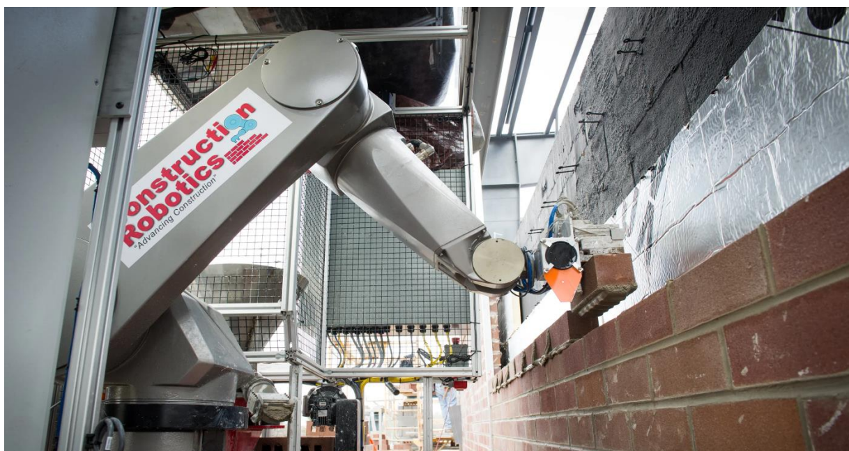
Рисунок 1: Пример робота-строителя в процессе укладки кирпичей
