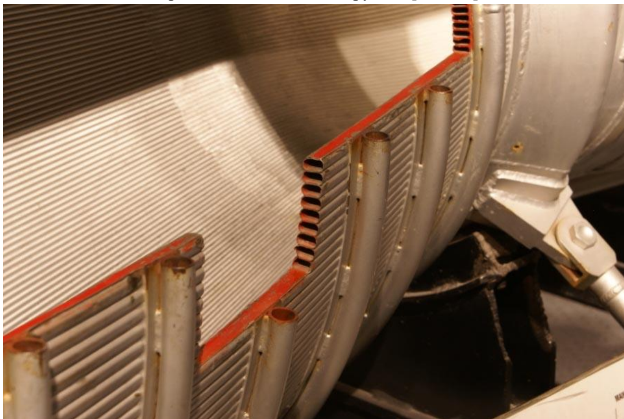
Рисунок 1 – Часть ЖРД в разрезе [10]
