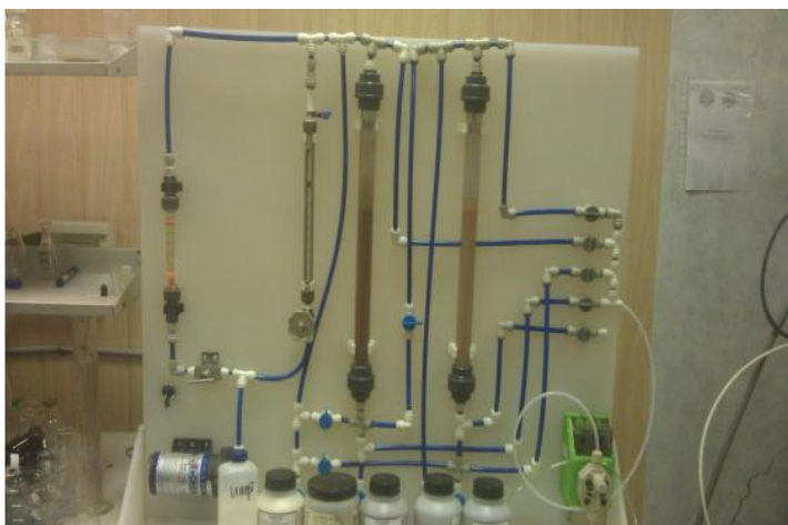
Рис. 2 - Внешний вид установки ионного обмена
