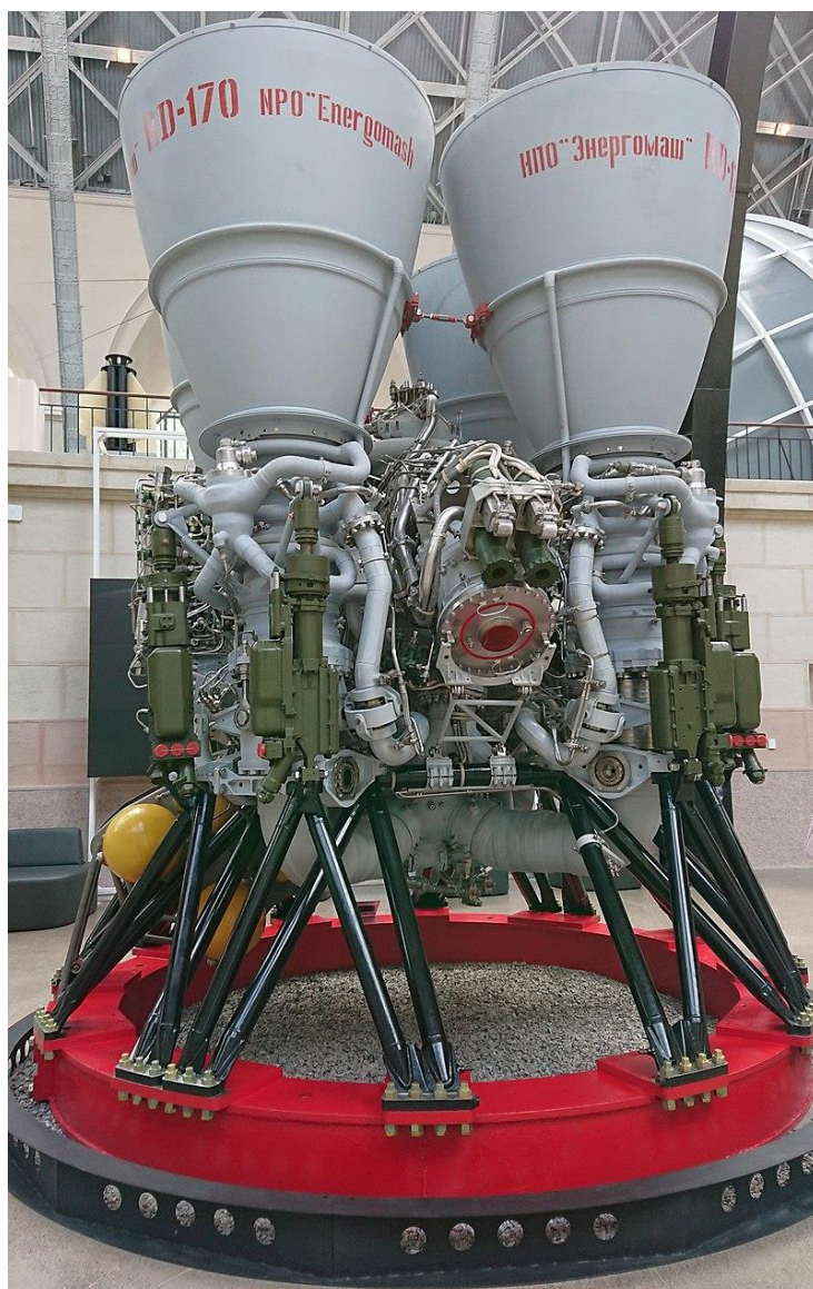
Рисунок 1. Жидкостный ракетный двигатель РД-170 производства АО «НПО Энергомаш имени академика В. П. Глушко» [3]
