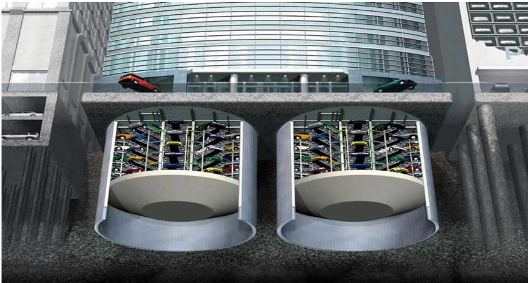
Рисунок 2 - Подземный многоэтажный автоматизированный паркинг (взято из [2])
