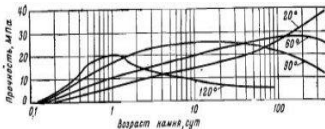
Рисунок 2 – Характер изменения прочности портландцементного камня во времени при разных температурах
