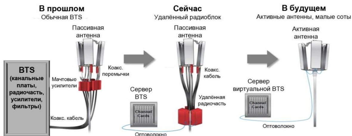
Рисунок 3. Эволюция антенн от пассивных к активным
