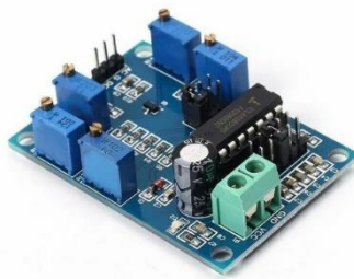
Рисунок 1. Макет генератора ICL8038
