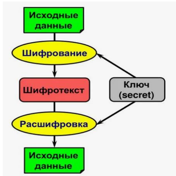
Рисунок 1. Симметричный алгоритм шифрования
