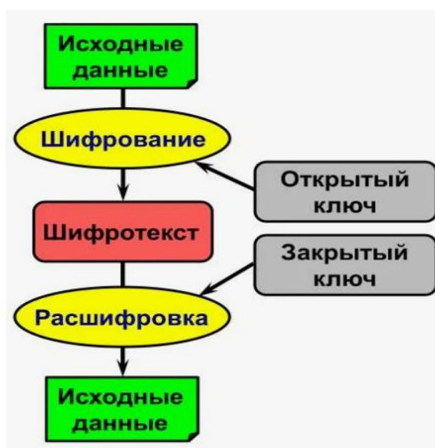
Рисунок 2. Асимметричный алгоритм шифрования
