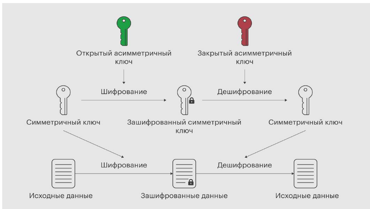
Рисунок 3. Гибридный алгоритм шифрования
