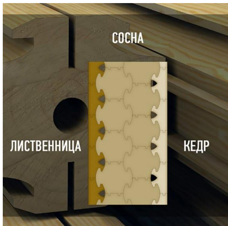
Рисунок 2 - Сечение стены по технологии NATURI с использованием кедровых внутренних ламелей и лиственничных наружных ламелей.
