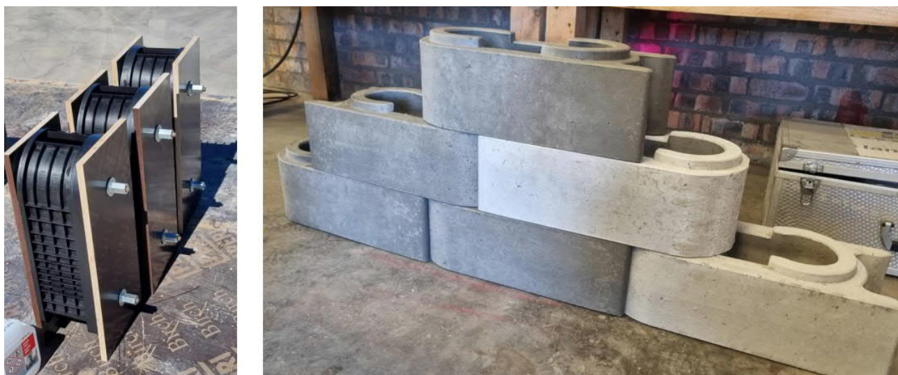
Рис.1 Изготовление блоков по технологии TwistBlock Moulds
