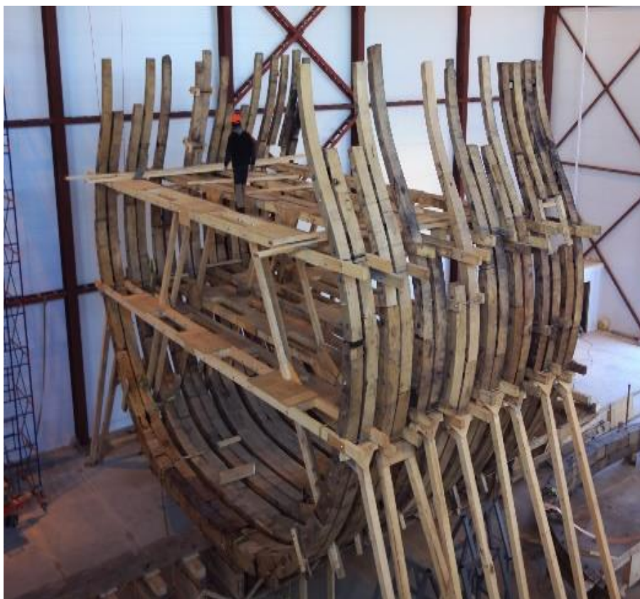
Рис. 1. Шпангоуты судна «Полтава»
