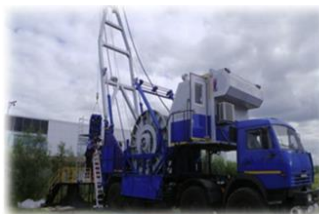
Рисунок 3. Установка «мини-гибкая труба»
