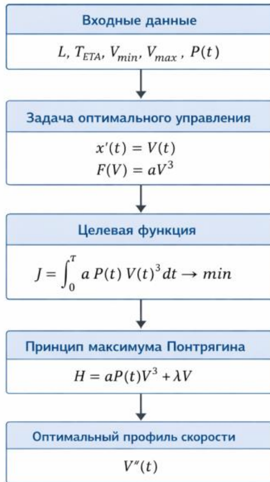
Рисунок 1. Структурная схема динамической оптимизационной модели выбора скорости судна при жестком ETA
